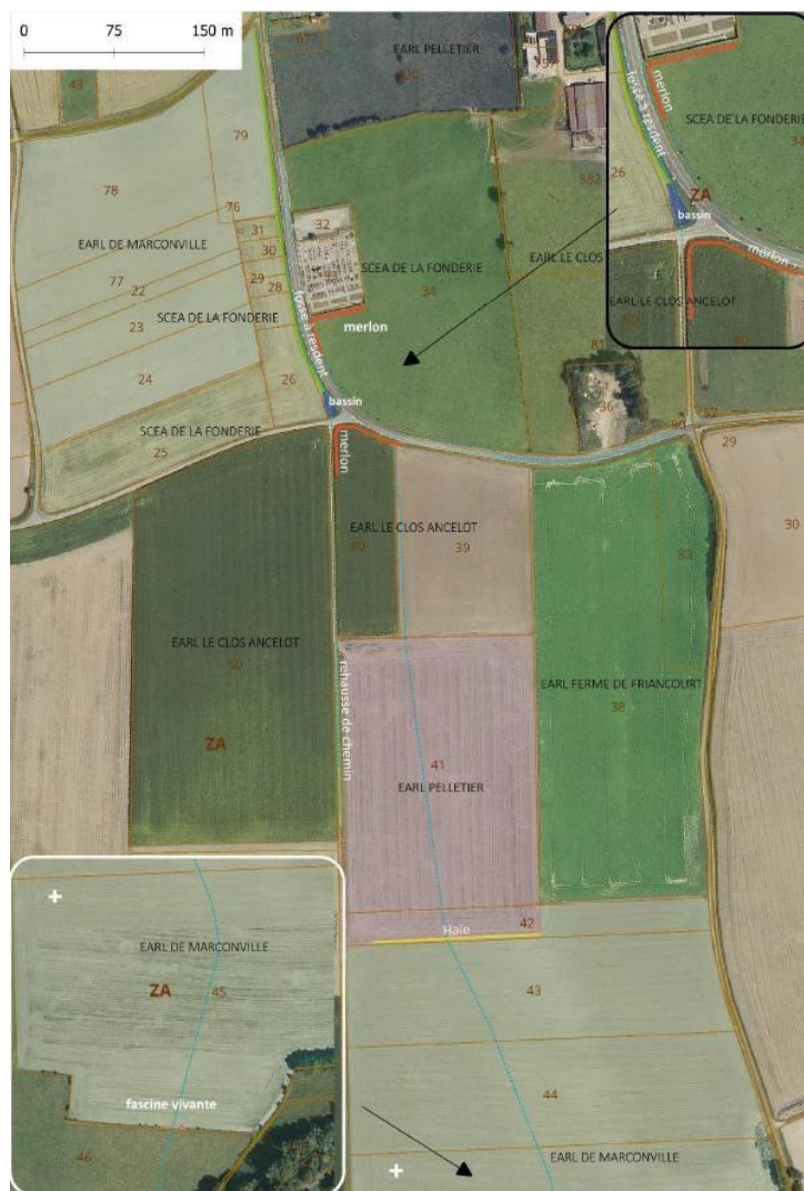
Figure 16 - dispositif pour ralentir les ruissellements
